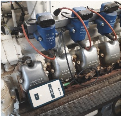
Compri im Einsatz an einem MAN E2842 Le312 4-Takt Gasmotor
