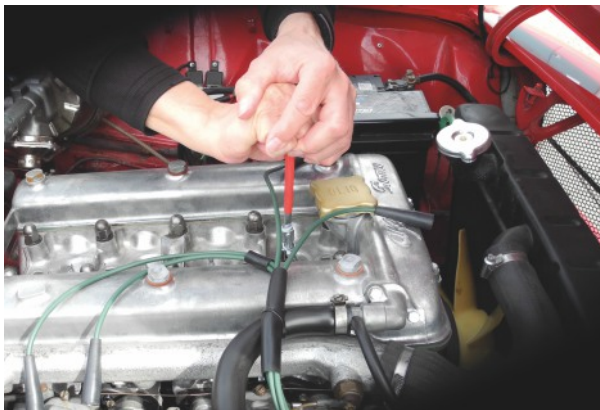
Ausbau der Zündkerzen an einem Alfa GT1300 Motor
