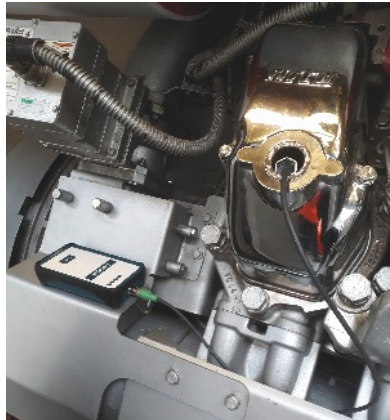
Compri im Einsatz an einem MTU 4000 (Powertec 1160) 4-Takt Gasmotor
